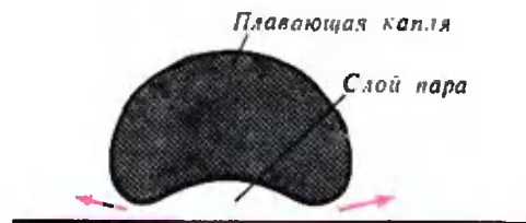
Рис. 2. Поперечное сечение капли Лейденфроста.
